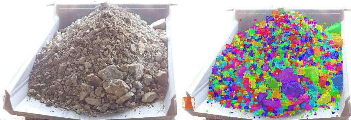
Abbildung 2: Erfassung der Korngrößenverteilung am Beispiel einer SLKW Ladung
