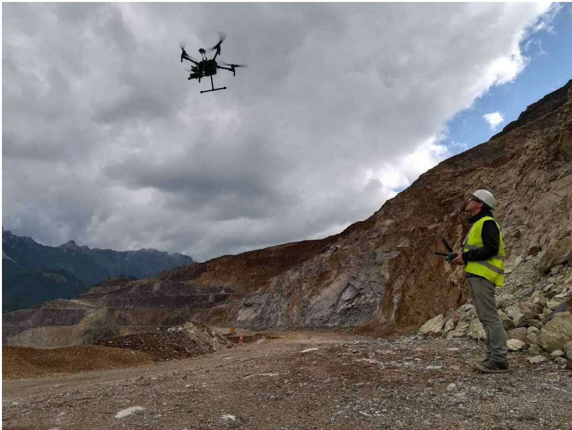
Abbildung 1: Drohnenbefliegung im Tagbau
